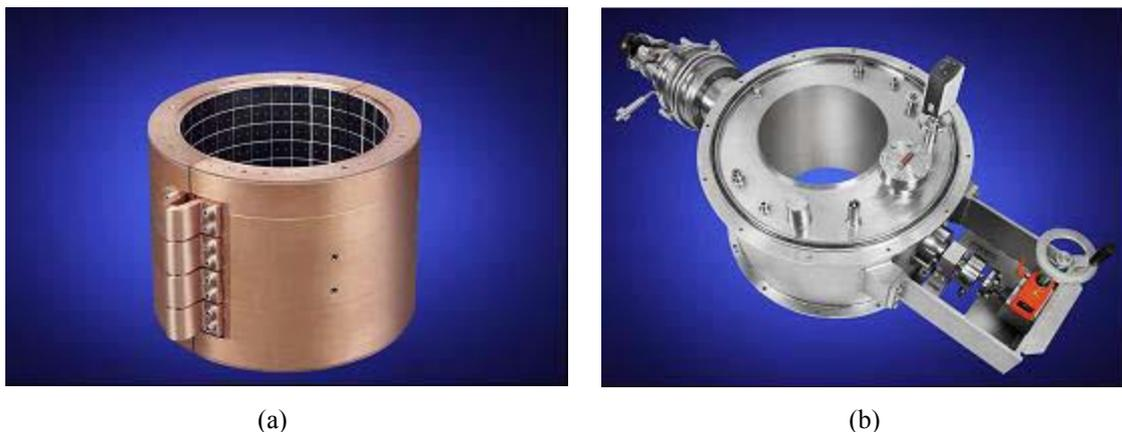
Figure I-11 Palier supraconducteur fabriqué par Nexans (a) Cylindre supraconducteur à base d'YBCO monté sur deux demi-coques en cuivre (b) enveloppe cryogénique.
