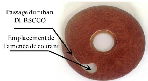
Figure II-13 Noyau de la bobine
