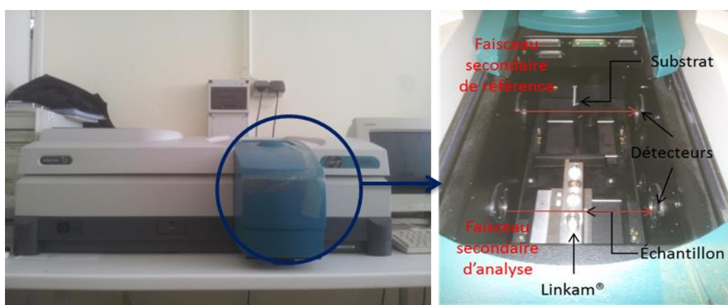
Figure II-15 : Présentation et montage du spectromètre UV-visible-proche infrarouge « Cary 5 000 » en configuration double faisceau
