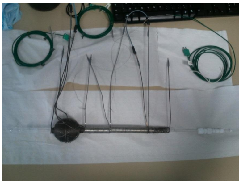
Le système réactionnel (réacteur/préchauffage) habillé par des bobinages d'éléments chauffants Thermocoax, qui sont directement enroulés à la paroi du réacteur.
