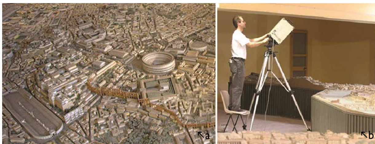
Figure 26. Détail de la maquette de Gismondi (a) et mise en place du capteur à triangulation (b) pour la numérisation VIVID 910 (Konica Minolta).
