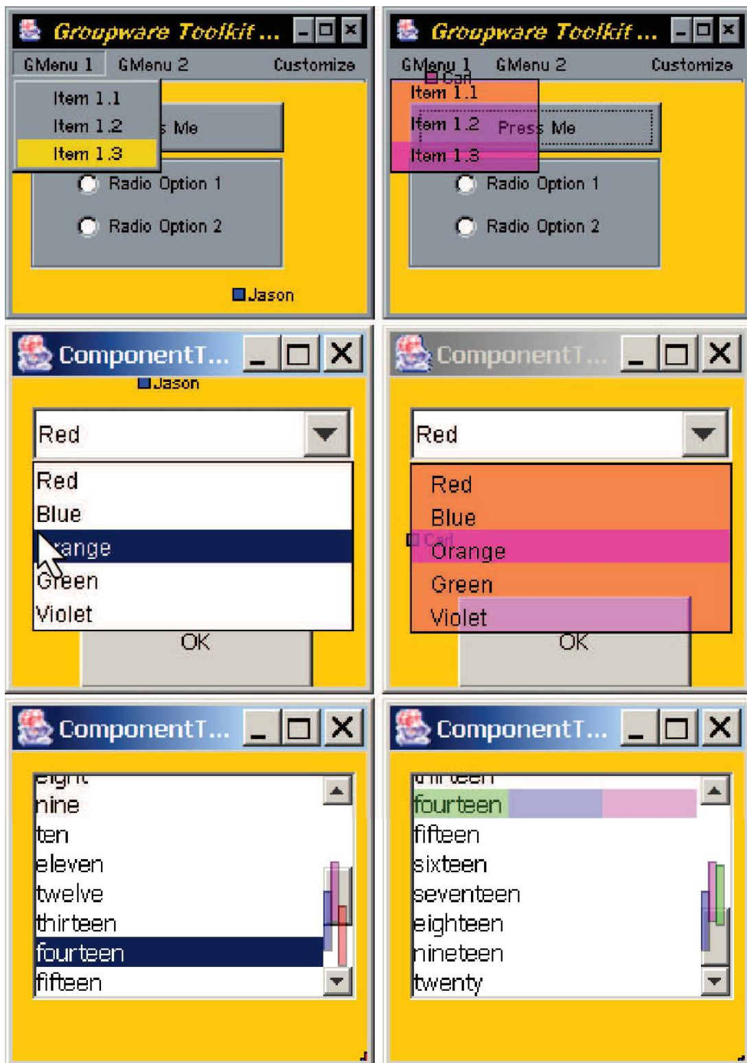
Figure 2.11 – Exemples d’interfaces conçues avec MAUI de Hill & Gutwin [58]. À gauche, l’interaction d’un utilisateur et, à droite, une autre instance de l’interface mettant en transparence les actions d’autrui.
