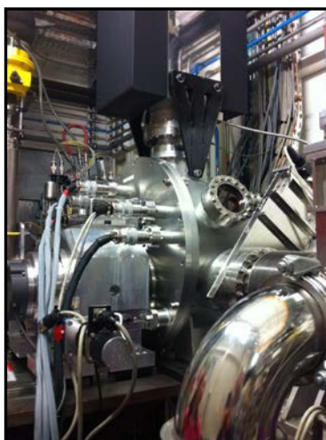
Figure 2. Photo de l'enceinte contenant le monochromateur à cristaux de la ligne Fame. Le monochromateur est refroidi à l'azote liquide
