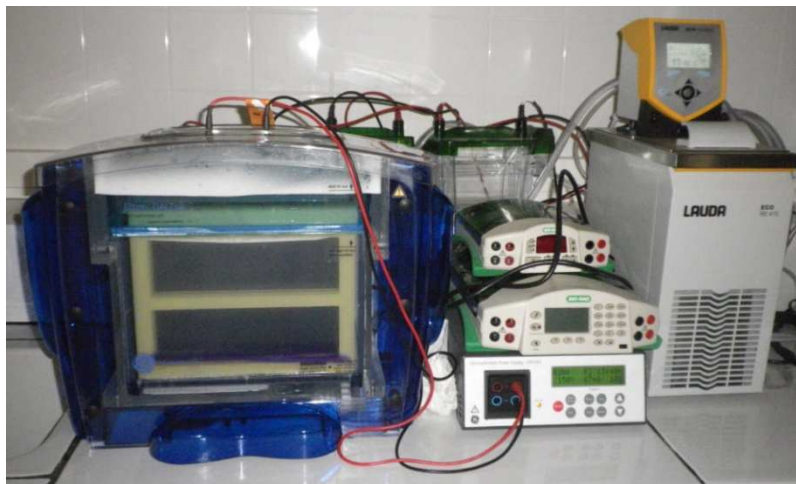
Figure 31: Vue de l'Ettan-Dalt6 (GE Healthcare) utilisé pour l'électrophorèse de type SDS-PAGE.
