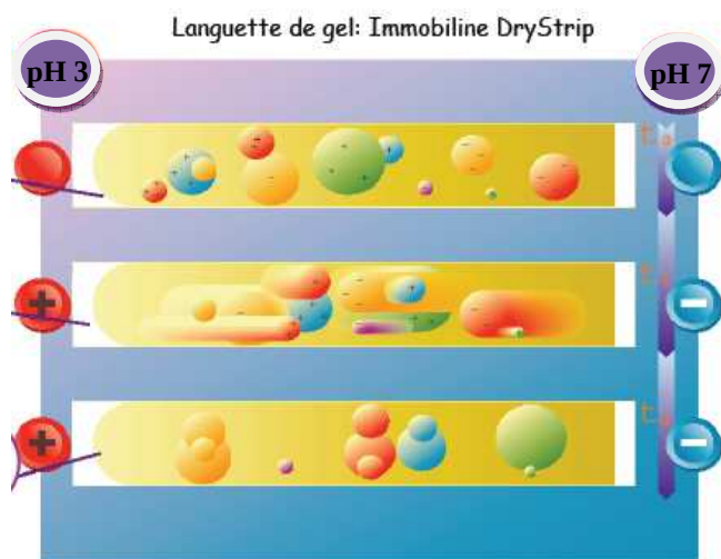
Figure 27: Schéma explicatif de l'électrophorèse de première dimension ou iso-électrofocalisation.
