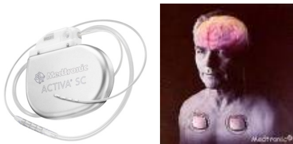
Figure 6 : A gauche, présentation d'une électrode reliée par une extension au boîtier de stimulation ; à droite, présentation du trajet des électrodes jusqu'aux boîtiers de stimulation (source Medtronic).
