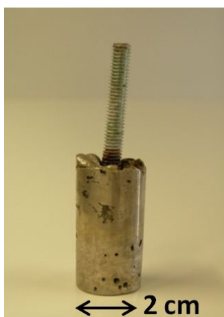
FIGURE 3.3 – Exemple d'une électrode de bismuth fabriquée au laboratoire
