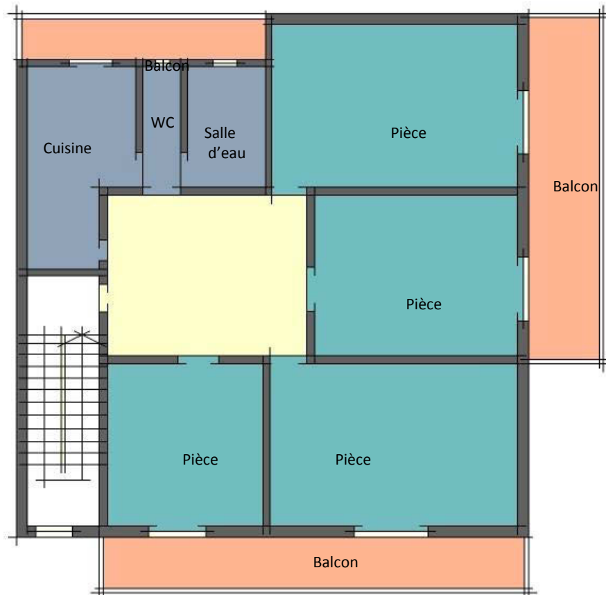
Figure 24 : Plan d'un immeuble de à six étages dans le quartier de Daf Alchouk. Tous les appartements ont les mêmes caractéristiques : quatre chambres, une cuisine, salle de bain et WC ; le patio n'existe pas dans de tels bâtiments. Source : enquête personnelle.
