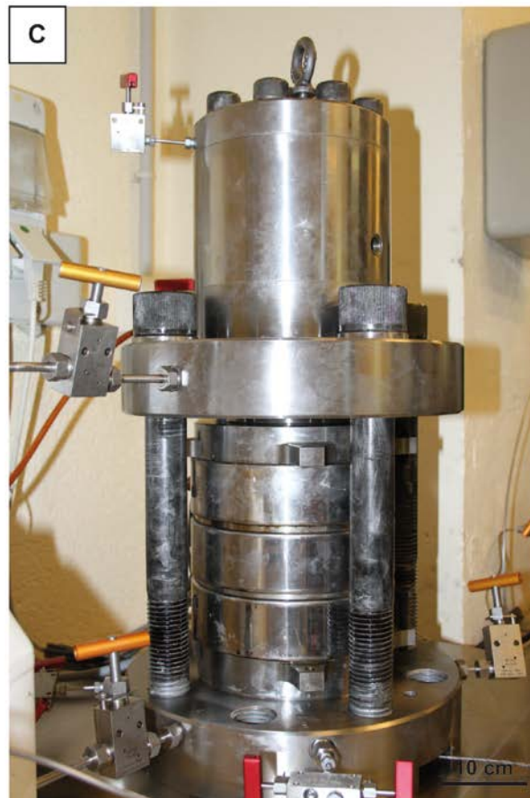
Figure 30. Photographies des étapes de montage de la cellule. (A) Montage du corps de la cellule, (B) remplissage par de l'huile de confinement, (C) mise en place du chapeau de la cellule et ajustement avec ses vérins.
