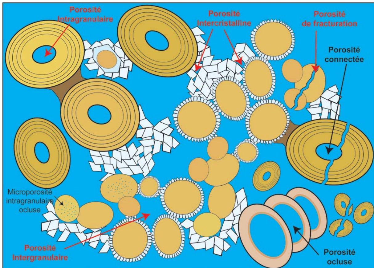
Figure 16. Caractérisation des différents types de pores dans un milieu granulaire. En rouge, les porosités de type génétique, en noir, les porosités de type pétrophysique.
