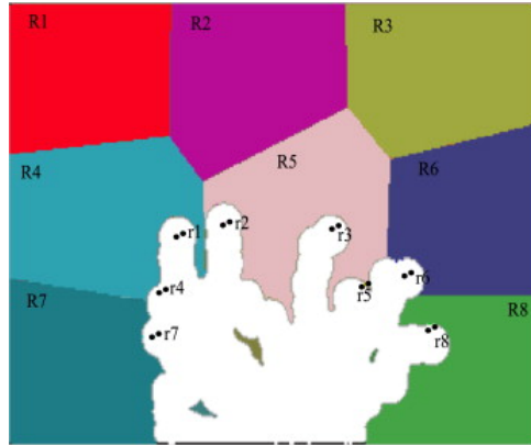
FIGURE 2.5 – Segmentation a priori de l'environnement avec l'algorithme K-means , K étant égal au nombre de robots. Une zone à explorer est ensuite affectée à chaque robot. (Puig et al., 2011)
