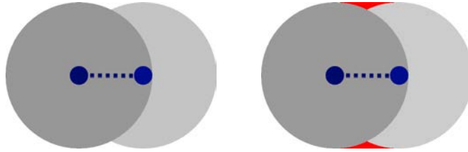
FIGURE 5.7 – Zone explorée quand le robot effectue une observation lorsqu'il arrive sur sa cible (à gauche) et quand sa fréquence d'observation est élevée (à droite). Les disques gris illustrent la zone perçue par le robot bleu. Le rouge illustre la différence entre les deux fréquences d'observation.
