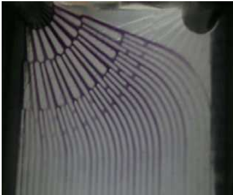
Figure 6.34 : Distribution expérimentale de la solution de nigrosine dans les canaux réactifs.
