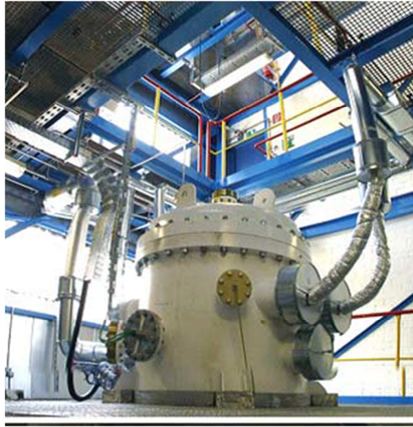
Figure 1.16 : Photographie du réacteur microstructuré construit dans le cadre du projet DEMiS®.
