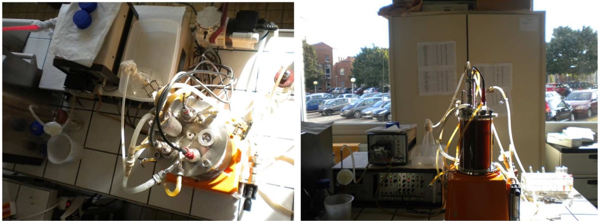
Figure 12: Fermenteur utilisé pour la production de bactéries probiotiques.
