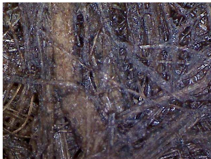
Figure 20: Vue du biocomposite LIN AT (x200)
