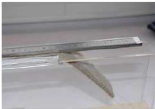
Figure 9 Appareil de mesure de l'angle de flexion
