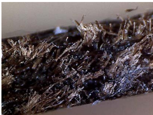
Figure 12 Lin bt vue en coupe grossissement 200 fois
