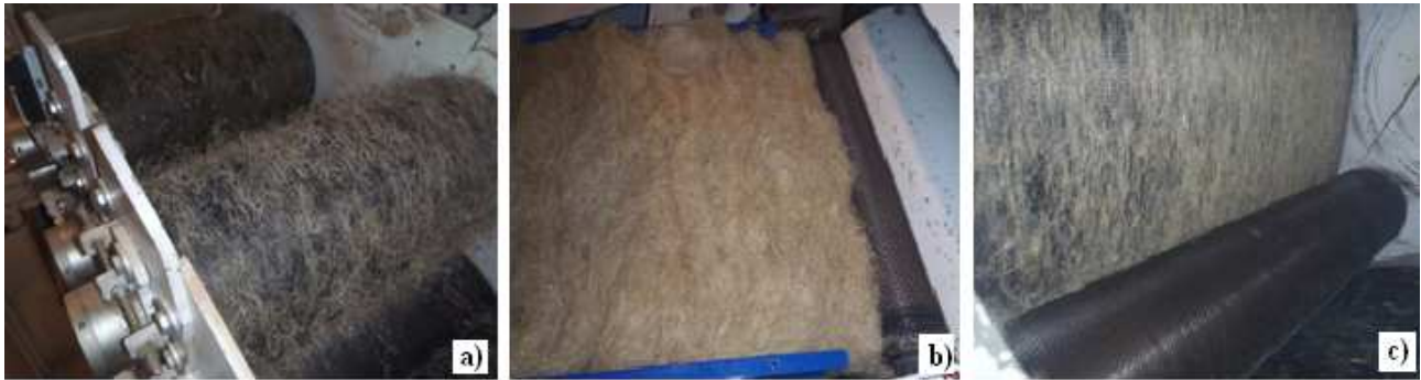
Figure 2 pour le réglage 5 de la fibre CHAN1 : a) vue des travailleurs b) matelas d'entrée c) vue du tambour principal
