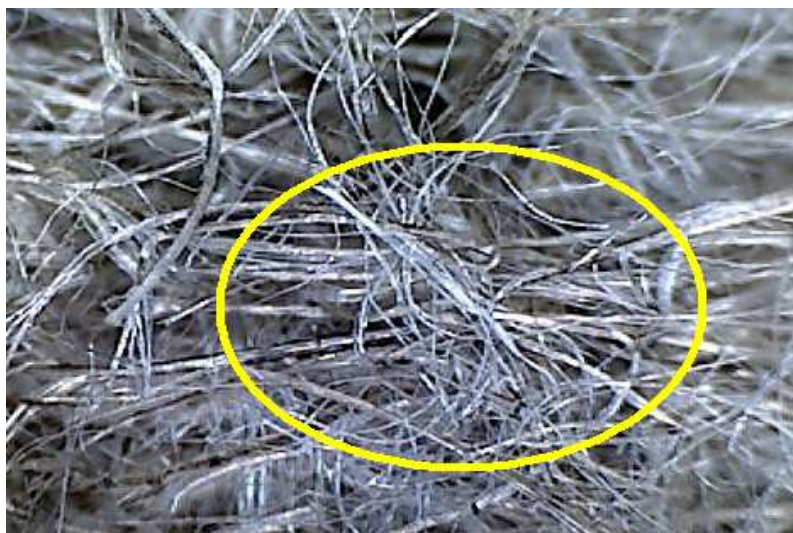
Figure 16 Renfort LIN D : vue du dessus (x35)
