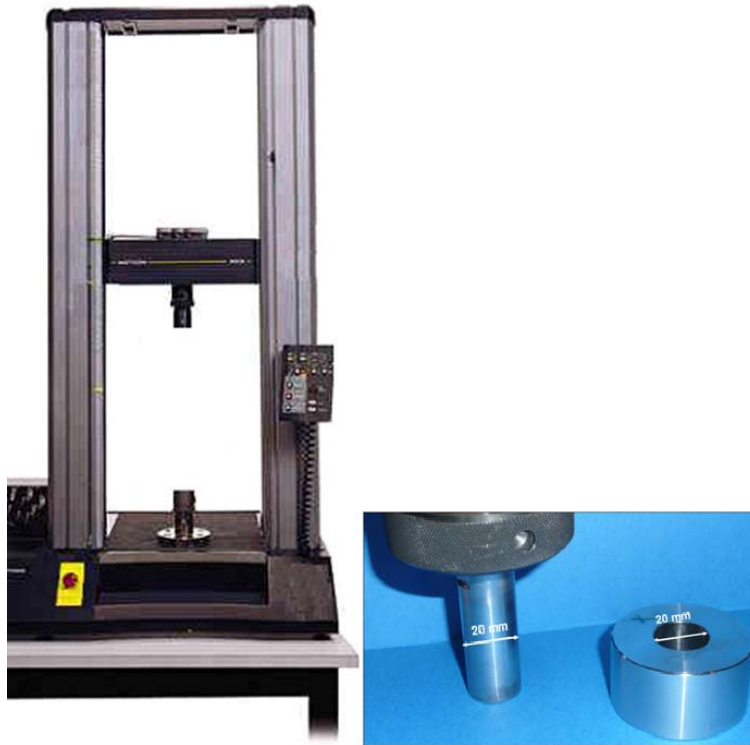
Figure 17 Photographies d'une presse uniaxiale Instron 5569® (à gauche), ainsi que du poinçon et de la matrice utilisée de diamètre 20 mm (à droite).
