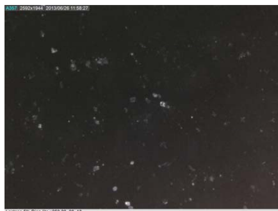
Figure 14 Observations en microscopie numérique du sirop de lactose à une concentration massique de 35%, après agitation de la solution pendant 24h. Agrandissement : 250x.
