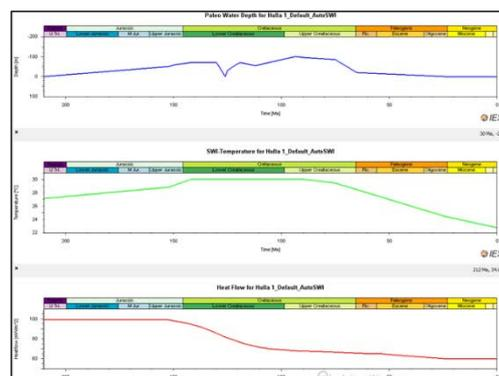
Anexo 5.2. Principales parámetros petrofísicos utilizados para la construcción y calibración de los modelos 2D, utilizando como base los parámetros petrofísicos del pozo Hulla-1.
