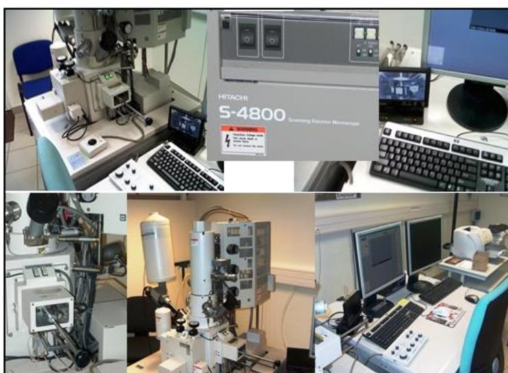
Figura 18. Microscopio Hitachi S4800, utilizado para el análisis de rocas madre y carbón.
