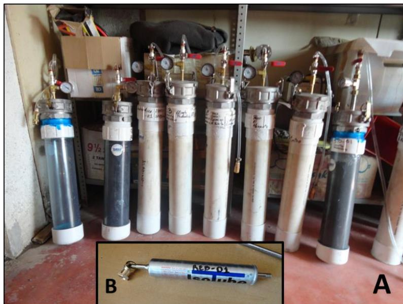
Figura 59. A y B: Fotografía A, Canisters de PVC, contruidos para muestrear gas de carbón. Fotografía B, Isotubo para desorber el gas de los Canister, y enviarlos al laboratorio de análisis isotópico.
