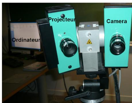
*Figure II. 23. Dispositif de numérisation*
