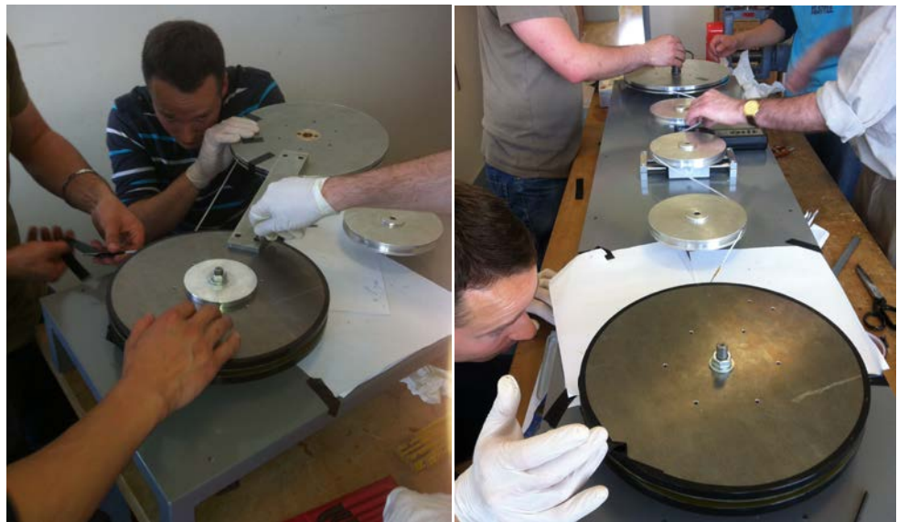
Figure A-3 : Photos prises lors de la réalisation de la bobine MgB2. À gauche, c'est la première galette qui est en cours de confection et à droite, la seconde.
