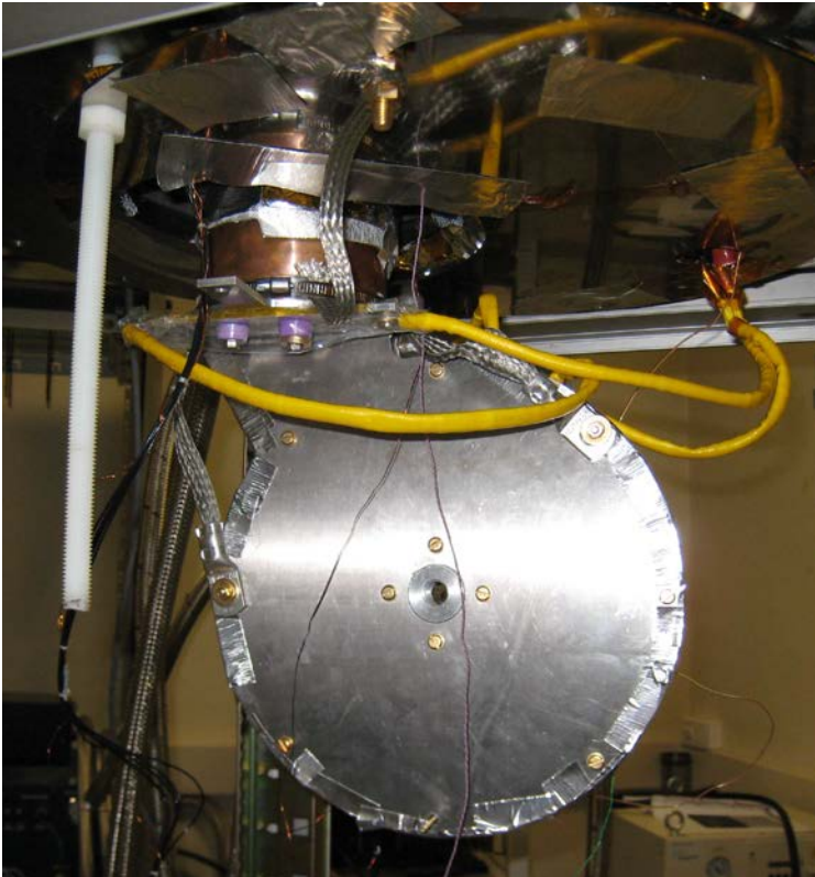
Figure 4-20 : Photographie de la bobine MgB2 montée sur son support qui est fixé à la tête froide.
