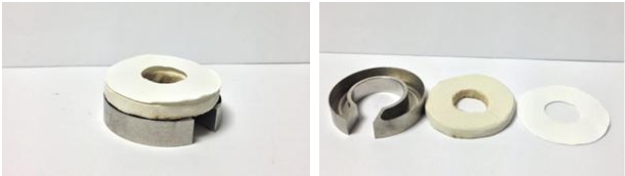
Figure II-10. Photos de la pièce anti-aérosols.
