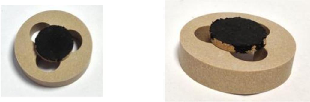
Figure II-12. Photos du support d'échantillons.
