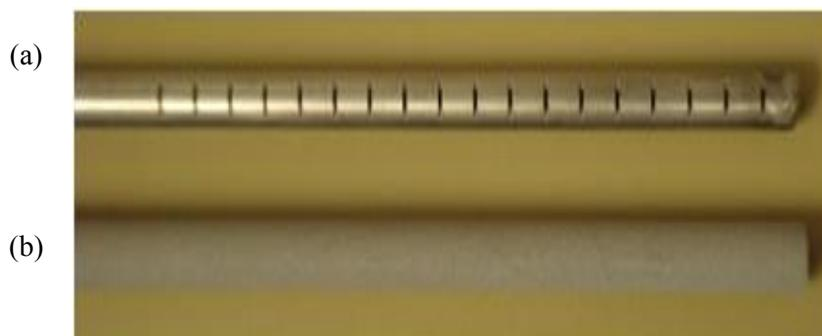
Figure II-5 : Distributeurs de gaz utilisés : (a) perforé et (b) poreux.
