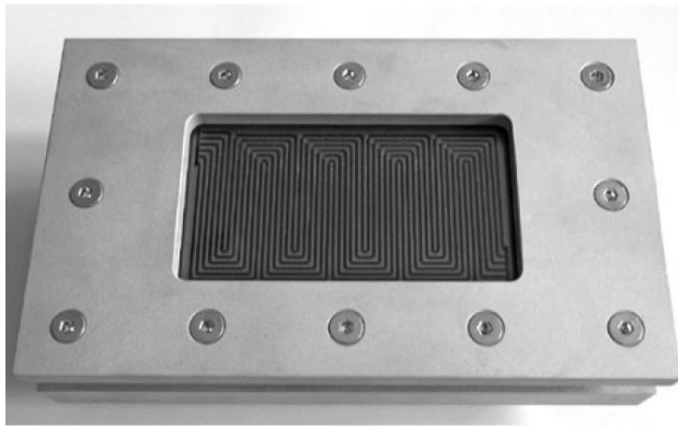
Figure I.29 : Photographie des canaux de la plaque bipolaire recouverts d'une plaque en silice [31]
