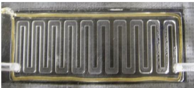
Figure I.20 : Photographie de la pile à combustible réalisée par les chercheurs et visualisation de l'eau liquide en sortie de canal [16]
