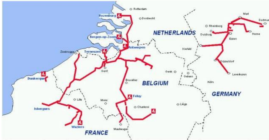
Figure I.6 : Le plus grand réseau d'hydrogène par pipeline en Europe du nord, exploité par Air Liquide [78]
