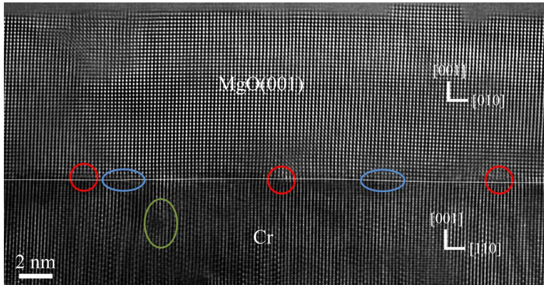
FIGURE 14.8 – Coupe transversale d’une interface Cr/MgO obtenue par microscopie électronique à haute résolution, selon l’axe de zone [100] du MgO, le trait blanc souligne l’interface et les marches atomiques qui s’y trouvent (ellipses bleues), les cercles rouges indiquent la présence de dislocations coin et l’ellipse verte d’un ensemble de dislocations vis.
