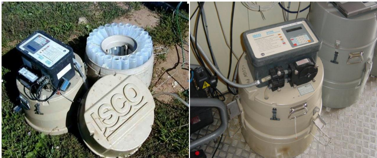
Figure 2.8 : Préleveurs automatiques employés pour les campagnes de mesures.
