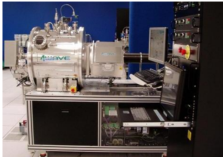
Figure 4-6 Bâti de gravure ionique IBE 4 wave, utilisé pour nos gravures ioniques.
