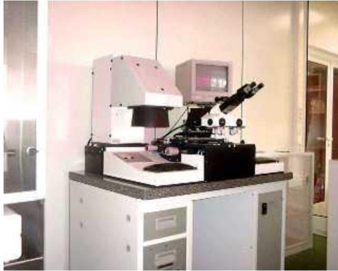
Figure 4-4 Aligneuse de masque et insolateur UV MA750. Photographie prise en salle blanche.
