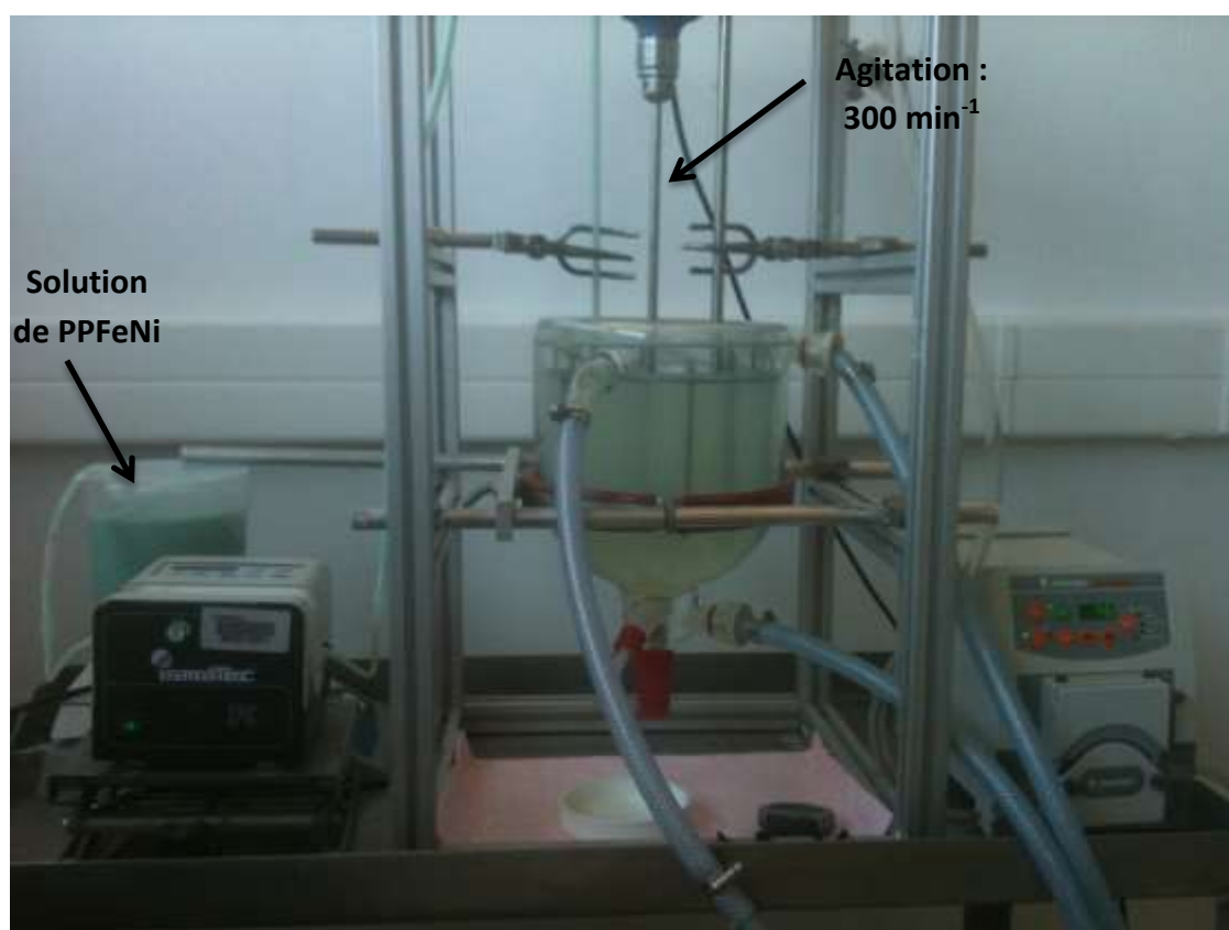
Figure 130 : Photographie du montage expérimental lors d'un essai de sorption du césium par le PPFenNi en réacteur continu classique
