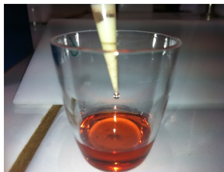
Figure 30: Drainage du liquide dans le cône capillaire (mode retrait).
