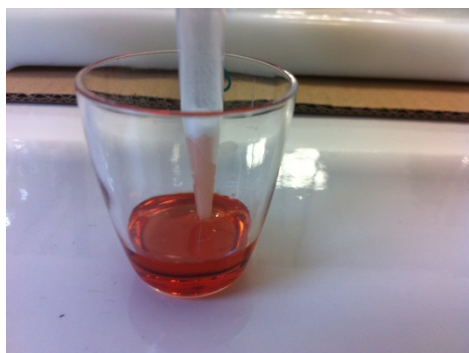
Figure 29: Monté du liquide dans le cône capillaire (mode avançant).
