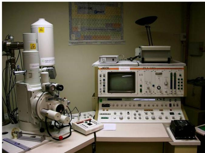
Figure II.3 : Dispositif de microscopie électronique à balayage.
