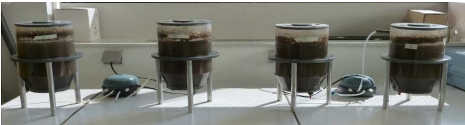
**Figure II-25** : Réacteurs batch de 4 L utilisés lors des expérimentations.
