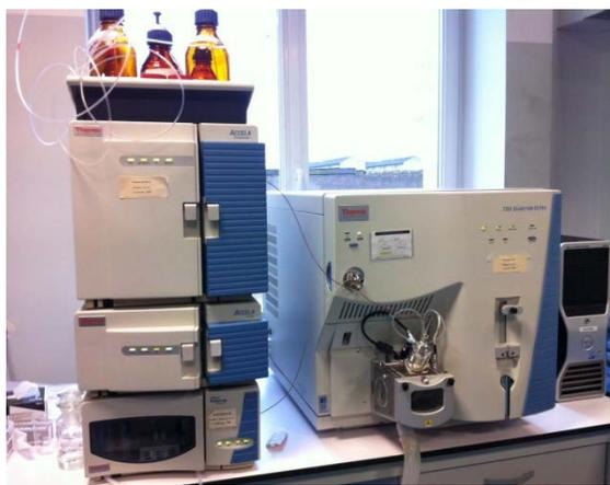
**Figure II-3** : Photo de l'appareil LC-MS/MS (Thermo Scientific).
