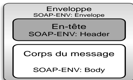
FIGURE 2.1 – Structure d'un message SOAP
