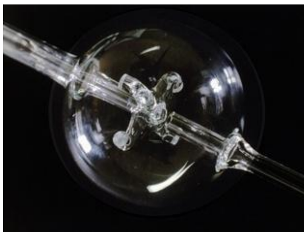
Figure 13: Le réacteur auto-agité par jets-gazeux
