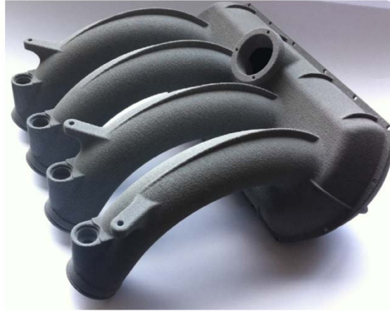
Figure II. 12 : Tubulures d'admission fabriqué directement par SLS à partir d'un mélange PA / AlCuFeB (Adaptée de [Ken 2012]).
