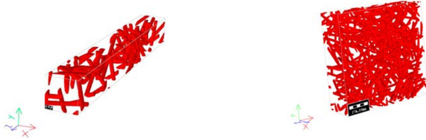
FIGURE 2.3 – Microstructures fibreuses générées avec GeoDict. Influence du type de calcul sur la création du domaine
