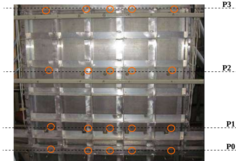
Figure 2- 12: Schéma de principe de l'échangeur à plaques et ondes de la section d'essais pour le calcul des pertes de pression
