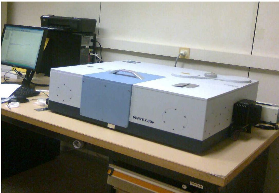
Figure II.17: Dispositif expérimental de spectroscopie d'absorption.
