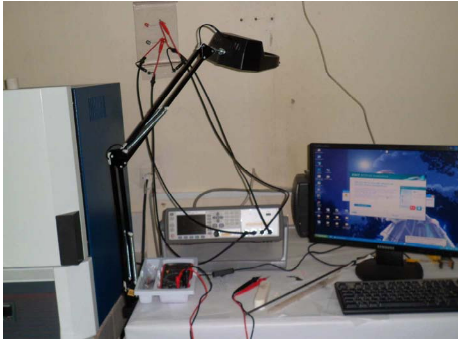
Figure II.18.a: Dispositif expérimental des mesures diélectriques.
