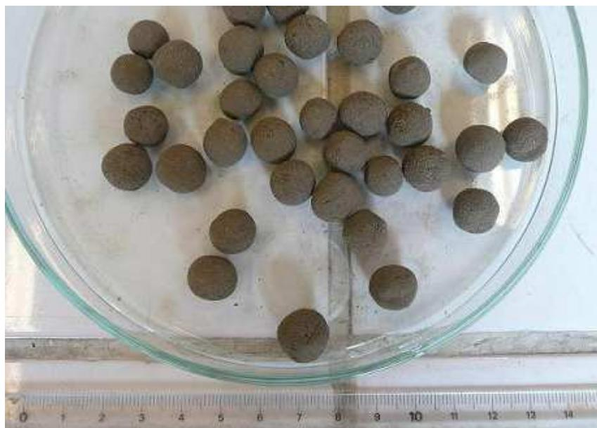
Figure 2.5 : Boulettes d'argile du Cameroun, façonnés à la main puis séchés à 35°C.
