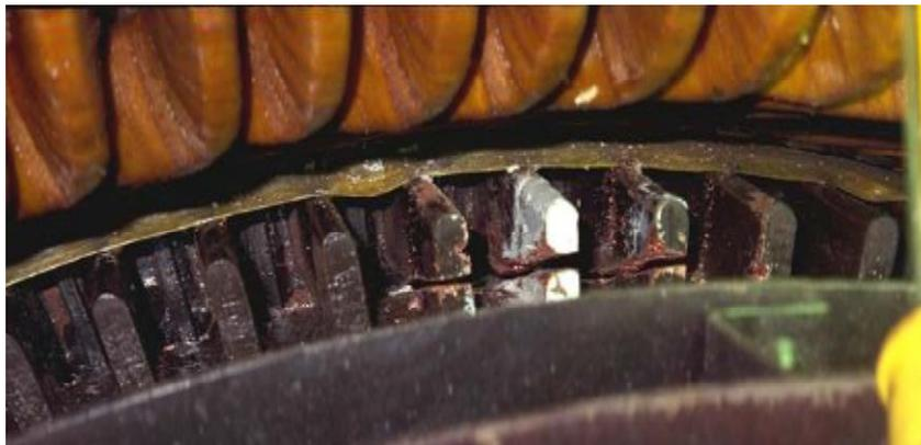
**Fig. I-5: Rupture de barres sur un rotor à cage extrait de [Tol02]**
