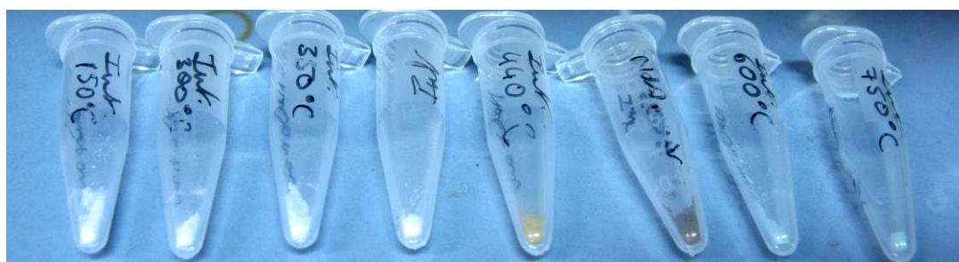
Figure 49 : Évolution de la poudre d'oxalate de néodyme au cours du traitement thermique (10°C/min sous air) : de gauche à droite, intermédiaires obtenus à 150°C, 300°C, 350°C, 395°C, 440°C, 500°C, 600°C et 750°C.
