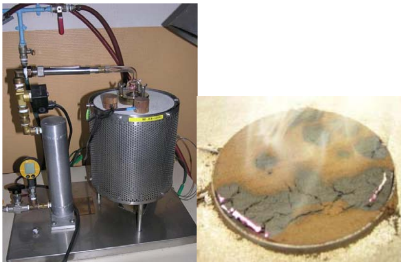
Figure 13 : Vues d'un four destiné à la mesure des TMI en nuage et d'un essai de TMI en couche (photos INERIS)
