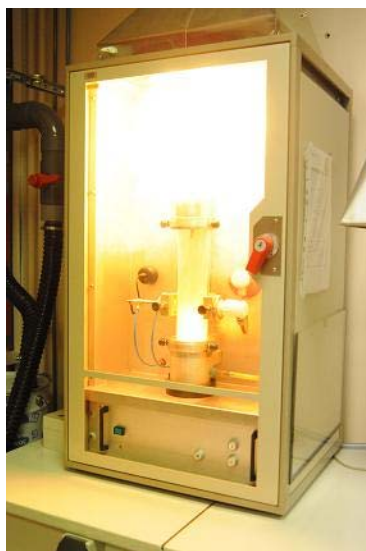
Figure 14 : Vue d'une inflammation au cours d'un essai d'EMI (photo INERIS)
