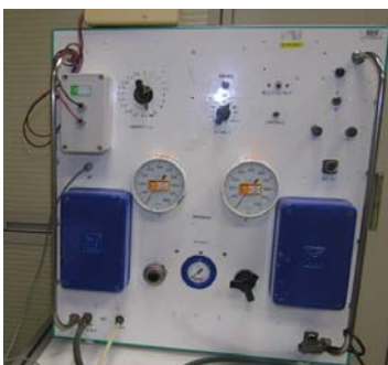
Interface de contrôle et de commande de l'inflammateur Hartmann
