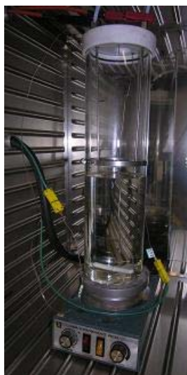
Figure 11 : Vue d'un tube destiné à la mesure des températures à la LIE et à la LSE (photo INERIS)
