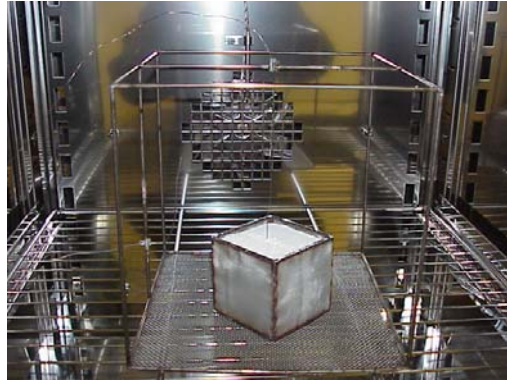
Figure 20 : Vue de l'intérieur d'une étuve, comportant le support de maintien du thermocouple et contenant un cube plein (source [56])
