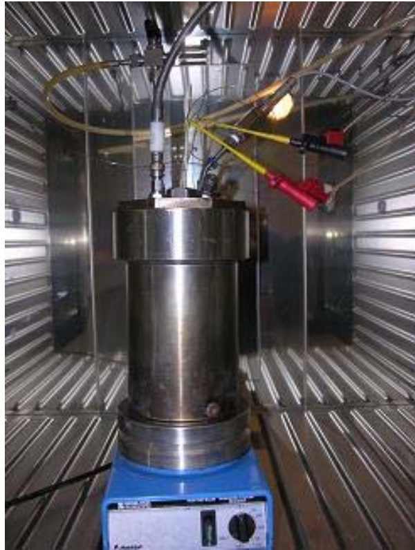
Figure 9 : Schéma de principe du tube (source : NF EN 1839 [23]) et vue d'une enceinte (photo INERIS), mis en œuvre pour la détermination expérimentale des limites d'explosivité des gaz et vapeurs respectivement en tube et en bombe
