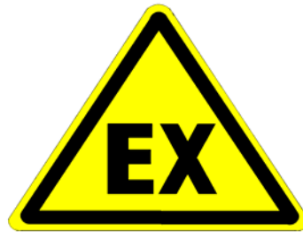
Figure 38 : Panneau de signalisation des emplacements où une atmosphère explosive peut se présenter
