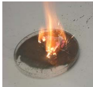
Figure 2 : Vue de l'inflammation spontanée de l'hydrogène dégagé par de l'hydrure de magnésium au contact de l'eau, au cours de l'une des phases préliminaires de la méthode N.5
