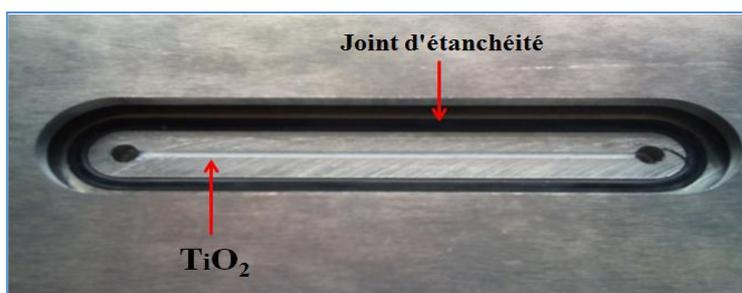
Figure II. 7 : Microcanal du Rinox imprégné de catalyseur.
