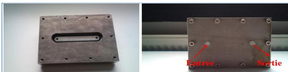
Figure II. 6 : Microréacteur Rinox fabriqué par usinage de précision.
