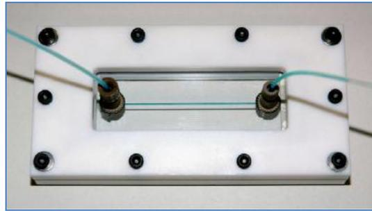
Figure I.11 : Microréacteur photocatalytique monocanal droit (Matsushita *et al.*, 2008).
