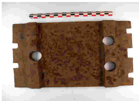
Figure 3.28 : photos des corpus d'échantillons analysés a. semelle et b. tube en fer La méthodologie analytique et les moyens techniques présentés dans le chapitre 2 ont été mis en œuvre afin d'appréhender les caractéristiques de ces systèmes, notamment la morphologie, la composition élémentaire et structurale des couches de produits de corrosion et leur réactivité.
