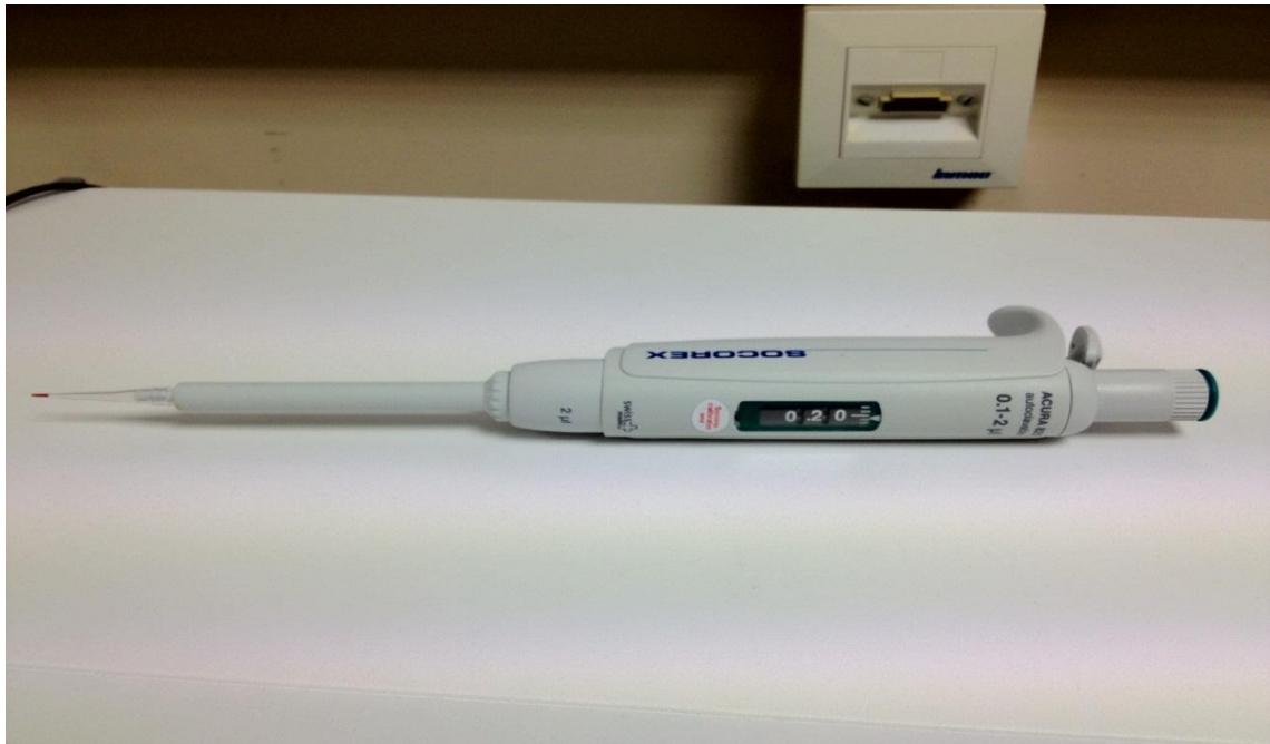
Figure IV-3 : La micropipette utilisée (Micropipette Socorex, Acura 825) pour déposer le volume fluide de 0.2 µl.
