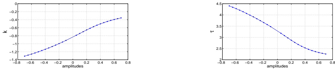
Figure A.12 – k et \tau de h_{61} en fonction des différentes amplitudes de kla_5 .
