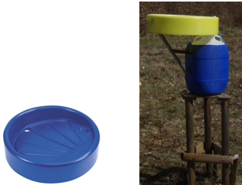
Figure 12 : Entonnoir en polyéthylène d'une surface de 0,22 \text{ m}^2 (à gauche) et capteur hors canopée complet en clairière (à droite)
