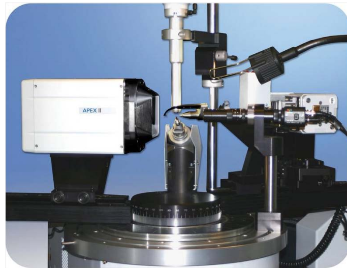
FIGURE 3.3 – Diffractomètre 3 cercles Apex II à détecteur CCD
