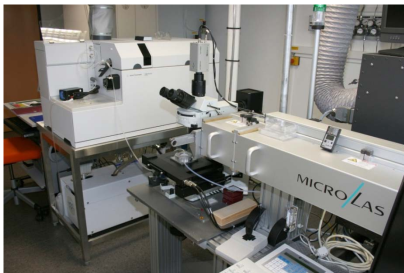
Fig. II.4 : Ablation laser ICP-MS installée à l'UMR G2R. On distingue le laser d'ablation (MicroLas) le microscope permettant de focaliser le laser et de contrôler le diamètre d'ablation. L'ICP-MS (série 7500, Agilent) est situé au dernier plan.
