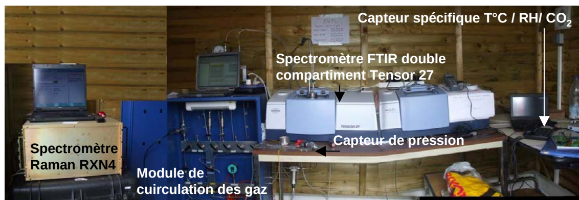
Figure 3.40 : Vue globale du module analytique de la plate-forme de monitoring géochimique dédiée à la mesure des gaz du sol sur le site de Rousse 1, pilote CO 2 Total de Lacq-Rousse, Pyrénées Atlantiques.
