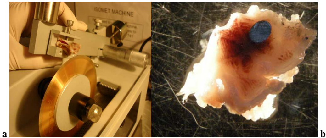
Figures 42 : Section par lame diamant à faible vitesse d'un fémur de rat (a) et analyse macroscopique d'une coupe de section os-implant titane (b)
