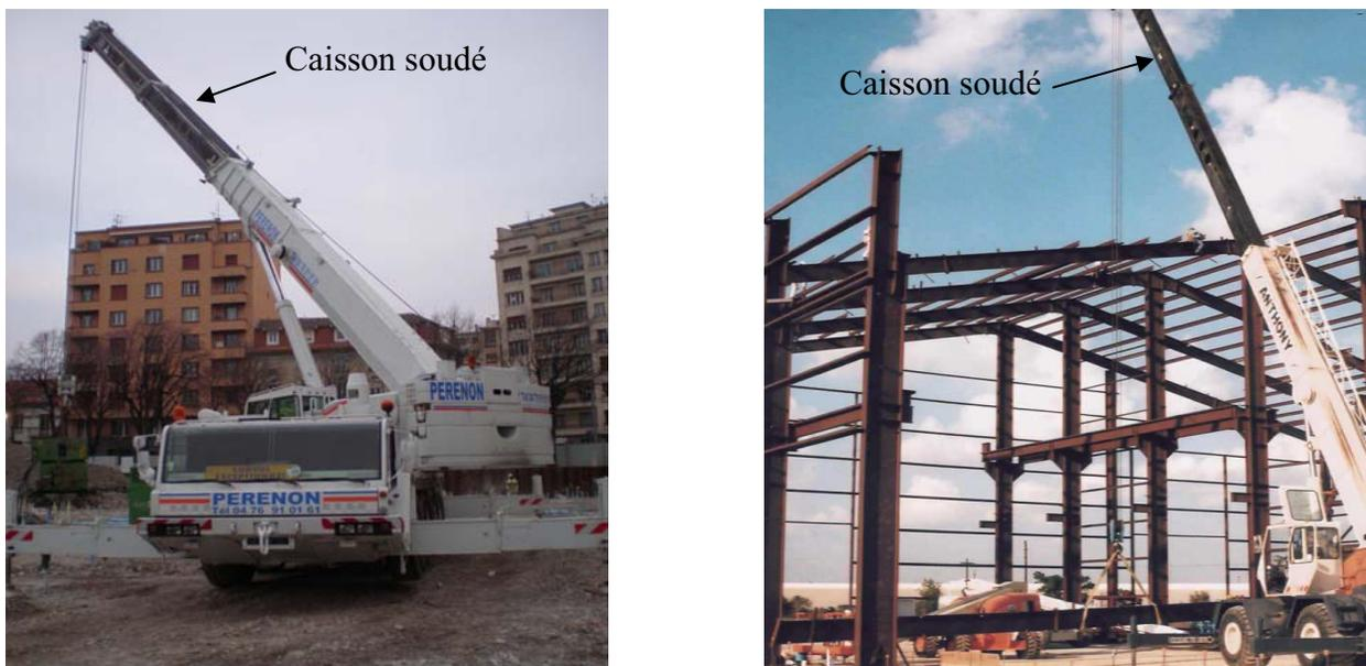
Figure 37 : Utilisation des caissons soudés dans les grues
