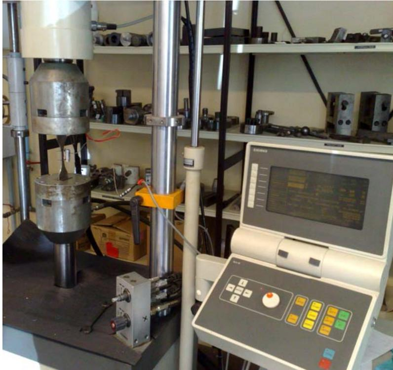
Figure 64 : Machine d'essai de fatigue plastique oligocyclique.
