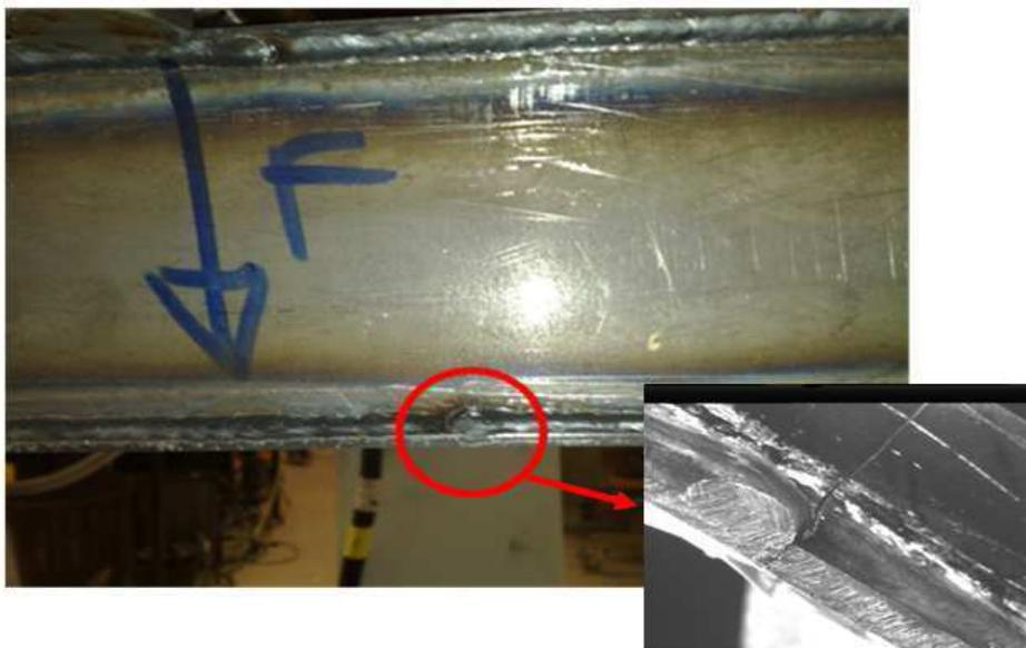
Figure 85 : Défaut à la surface de cordon de la soudure
