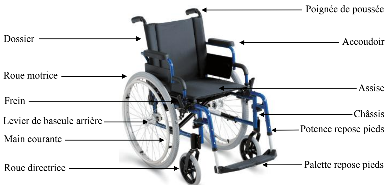
Figure 29. Principaux éléments constitutifs d'un fauteuil roulant manuel standard.
